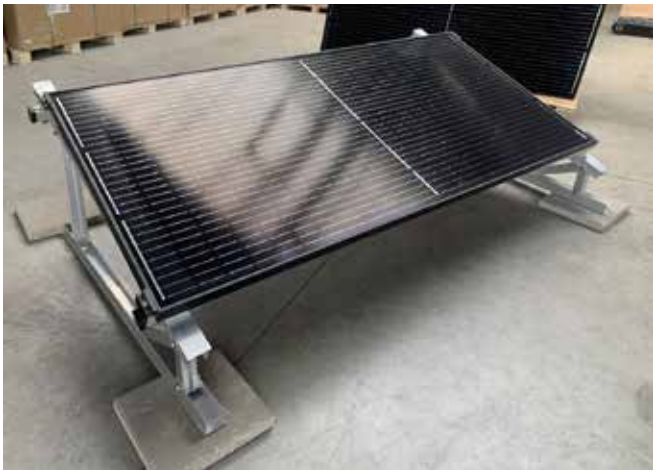
Abb. 1.2.: Montage mit 1 Modul - horizontal, auf Tiefbordstein (ca. 20 kg) mit Bautenschutzmatte
