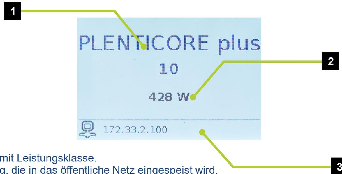
1. Wechselrichter Typ mit Leistungsklasse.
