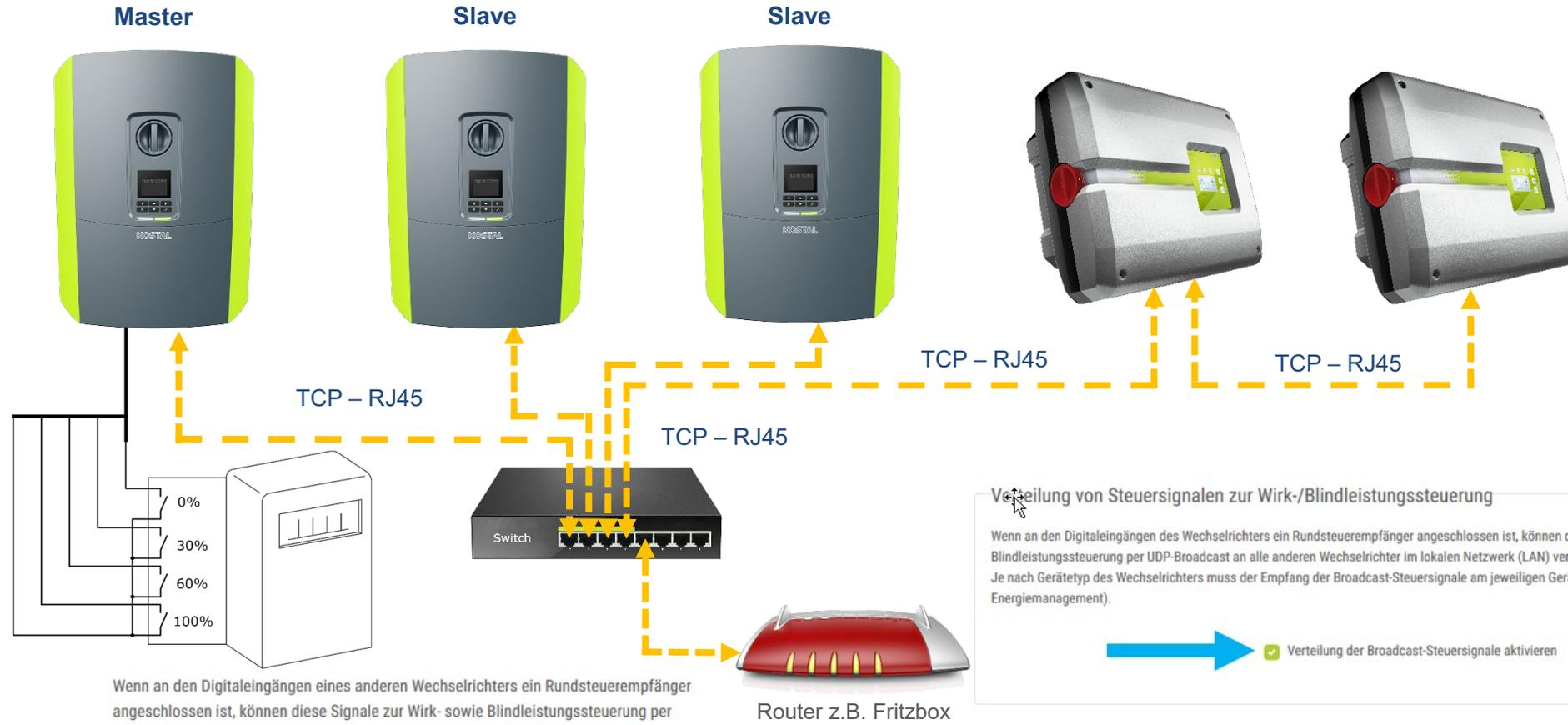
**Verteilung von Steuersignalen zur Wirk-/Blindleistungssteuerung**
