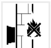
Wechselrichter auf nicht entflammbarer Montagefläche montieren.
