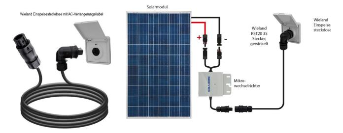
Schritt 7: PV-Module an Mikrowechselrichter anschließen
