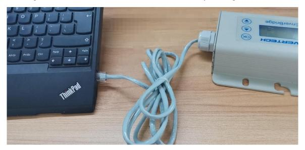
Bei dem Start der EnverBridge muss dann direkt die **OK** Taste betätigt werden. Im angezeigten Boot Menü wählen Sie "**Update System**" und bestätigen dies mit **OK**. Das Update beginnt automatisch.
