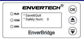
Einstellungen von Sicherheitsparametern in Bezug auf die Mikrowechselrichter. Diese Einstellungen dürfen nur von dem Service Personal verändert werden! Sicherheitseinstellungen für den Anwender werden über das **Hauptmenü** unter dem Punkt \*Set MI Saftety Param vorgenommen.
