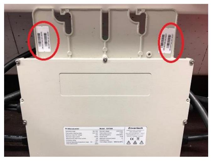
Die Zuordnung der Seriennummern ist nur bei der EVB202 Software erforderlich – bei der EVB201 Software werden die Mikrowechselrichter automatisch über die Stromphase erfasst (**SN im Portal sichtbar**). Dadurch soll festgelegt werden, welche Mikrowechselrichter von der EnverBridge erfasst werden. Es ist auch zu beachten, dass lediglich die aktuelle EVB202 Software die Höhe des Energieausgangs der Mikrowechselrichter an das AC Netz steuern kann.
