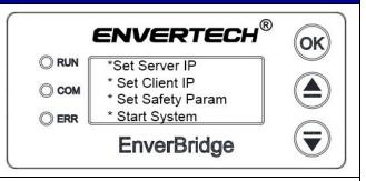
Das Boot Menü wird durch direktes Betätigen des **OK** Buttons im Zeitpunkt des Einsteckens des Netzsteckers aktiviert. Die dort befindlichen Einstellmöglichkeiten wirken sich unmittelbar auf den Betrieb der EnverBridge aus. Nehmen Sie keine Einstellungen vor, über deren Auswirkung Sie keine Kenntnis haben!
