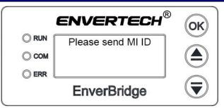
Durch Auswahl des Menüpunktes "**Set MI ID**" und anschließender Bestätigung erwartet die EnverBridge die Zuordnung der Mikrowechselrichter Seriennummern durch das Windows Programm **SetID**. Genaueres dazu finden Sie unter Punkt **4.3** ab Seite **22**.
