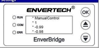
Manuelle Einstellungen in Bezug auf den Leistungsfaktor. Die EVB202 steuert die Leistungserzeugung der Mikrowechselrichter jedoch automatisch für ein bestmögliches Ergebnis.
