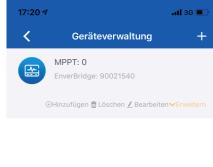
Unter "MPPT: 1" wird die bei der Einrichtung angegebene EnverBridge mit deren Seriennummer angezeigt. Darunter befindet sich der Punkt "+ Hinzufügen". Durch betätigen öffnet sich ein Eingabefenster, wo die Seriennummer des zu erfassenden Mikrowechselrichters (CN...auf OVP bzw. Gerätegehäuse) eingetragen wird. Der Mikrowechselrichter wird dann entsprechend aufgelistet mit den letzten 8 Ziffern der Seriennummer.
